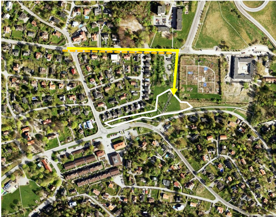
Figur 7. Gul linje och pil markerar skyfallsvägen i Skogsviksvägen. Orange streckad linje visar den upphöjning som gjorts för att se till att flödet inte smiter söderut. Vit markering visar ungefärlig placering av fördröjningsdamm.
